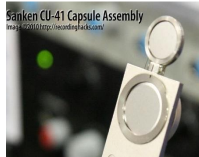
Fot. 2. Kapsuła pojemnościowa z folii tytanowej ( http://recordinghacks.com )
