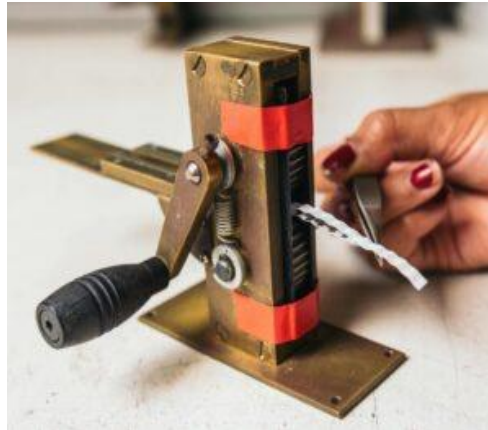
Fot. 29. Maszynka do ręcznej korugacji wstęgi mikrofonu ( www.aearibbonmics.com )
