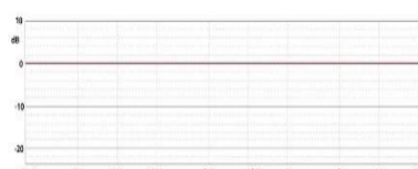
Rys. 7. Charakterystyka częstotliwościowa kapsuły Schoeps MK2 ( www.schoeps.com )
