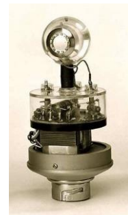
Fot. 9. Mikrofon Neumann M50 wewnątrz (www.recordinghacks.com)
