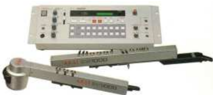
Obraz 29. W porządku od góry do dołu: Analogowy moduł dźwiękowy EWV 2000, EWI 1000 (Electronic Wind Instrument 1000), EVI 1000 (Electronic Valve Instrument; jego wygląd przypomina w budowie trąbkę wentylową). Obydwa instrumenty łączone były z modułem za pomocą tzw. „kablów multi” dodawanego w pakiecie.
