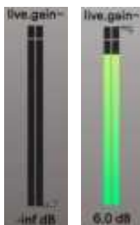
Obraz 65. Wygląd Testera Sygnału w stanie nieaktywnym (lewy suwak) i przy maksymalnej głośności (prawy suwak).
