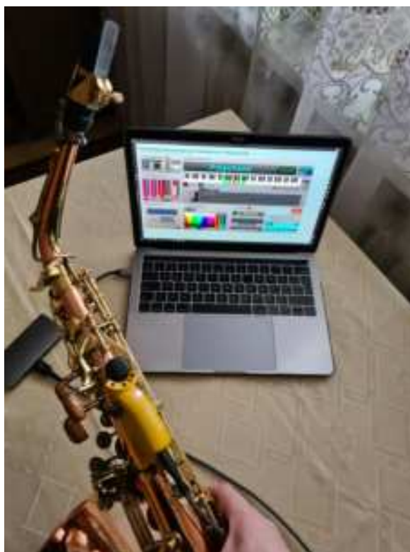
Obraz 39. (i 54.) Wygląd oprogramowania oraz prototyp pilota zainstalowany na korpusie saksofonu altowego Buffet Crampon Prestige S3.
