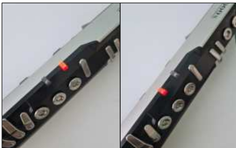
Obraz 36. Przedstawienie aktywnych funkcji wielogłosowości. Na zdjęciu po lewej stronie widać włączoną funkcję burdonu, zaś z prawej strony – interwału.
