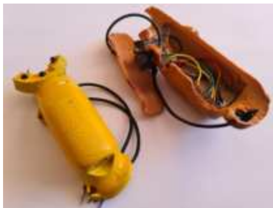
Obraz 41. Widok na osłonę pilota oraz wgląd w jego wewnętrzną konstrukcję – w tym połączenia kablowe, przyciski, diodę i płytkę z mikrokontrolerem (w skrócie: czipem).
