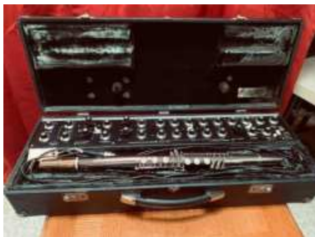
Obraz 28. Wygląd Lyriconu I z syntezatorem analogowym (modułem dźwiękowym). Komplet mieścił się w jednym futerale.
