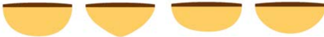
Ilustracja 19: popularne profile szyjek gitarowych (od lewej) U, V, D, C
