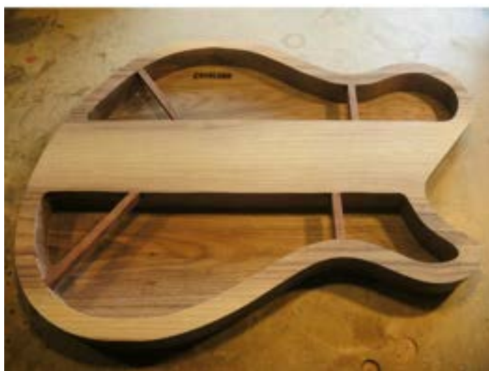
Ilustracja 15: wnętrze korpusu semi hollow body wykorzystujące blok centralny
