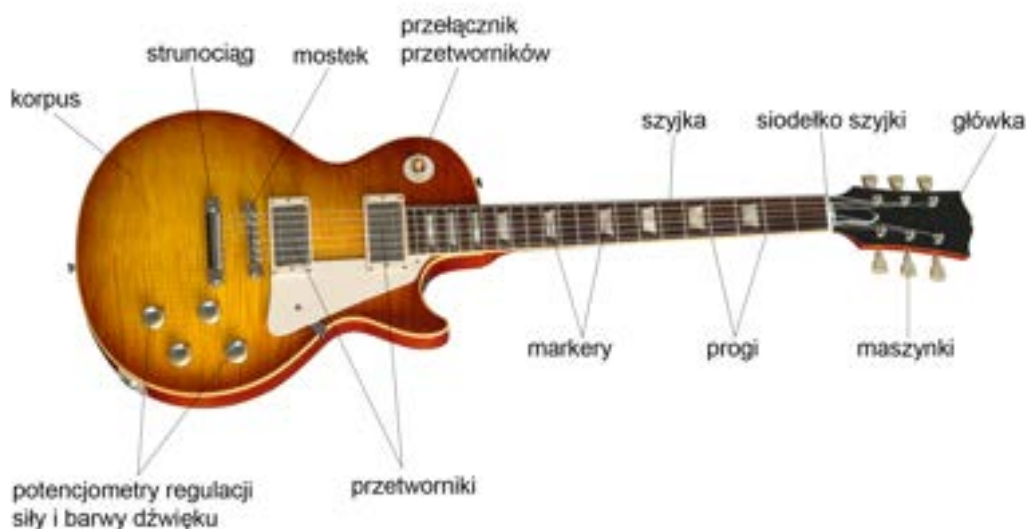
Ilustracja 12: budowa gitary elektrycznej
