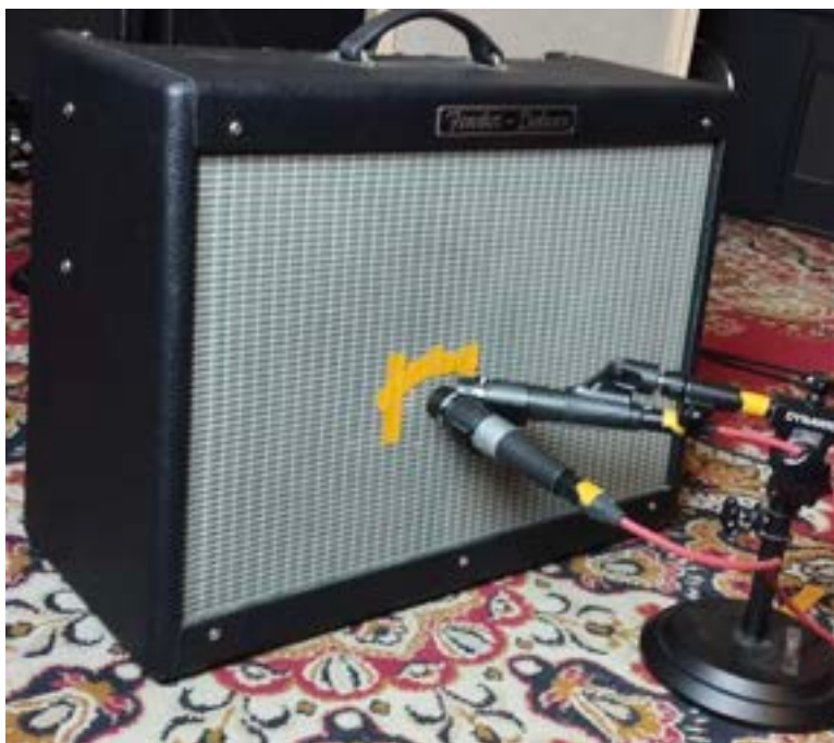
Ilustracja 46: mikrofony użyte podczas nagrań ustawione techniką Fredmana
